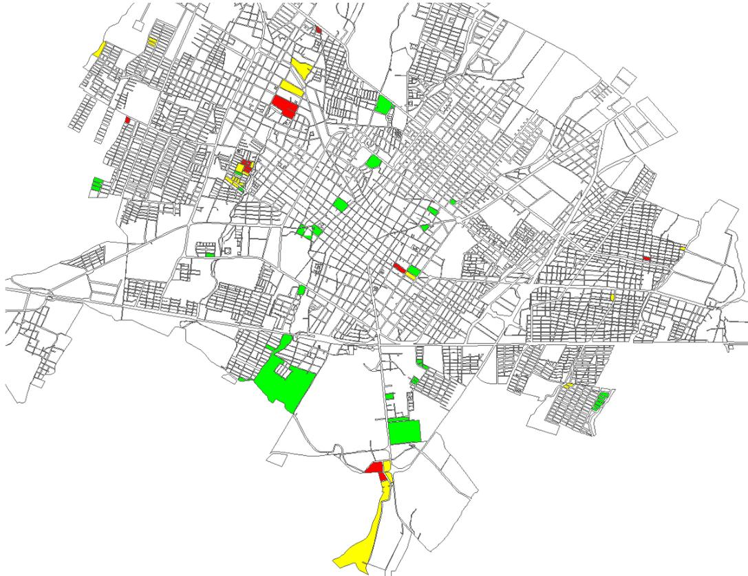
**Figura 6.9** Mapa de riesgo por inundación en manzanas urbanas debida a desbordamiento de cauces
