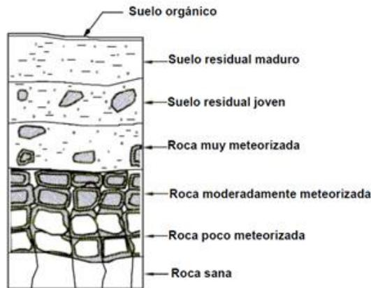
Figura 5.70.- Perfil de alteración de un suelo residual y de la roca basal.
