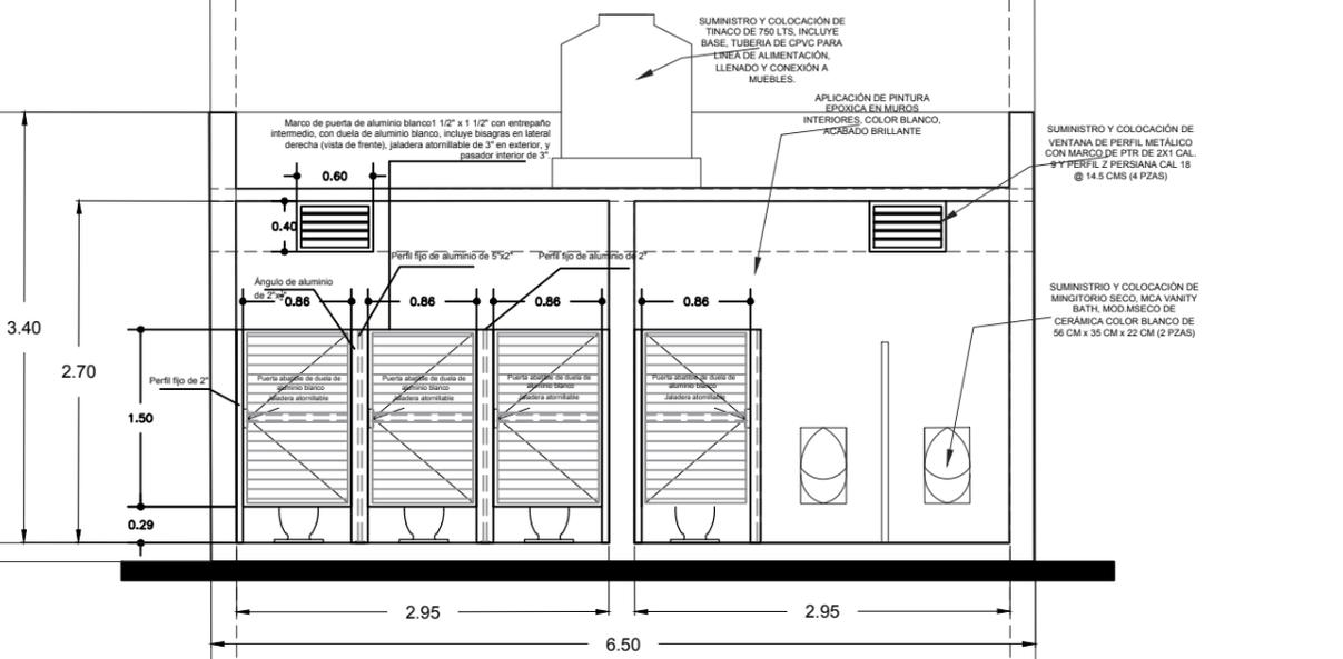
**SECCION LONGITUDINAL - A-A' MÓDULO DE BAÑOS**
