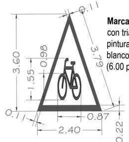
Marca en pavimento Pictograma de bicicleta de 2.40x3.60 m con triángulo que delimita la figura de la bicicleta, a partir de pintura para tráfico base solvente de secado rápido en color blanco y microsfera reflejante en una proporción de 700 gr/l. (6.00 pzas)
