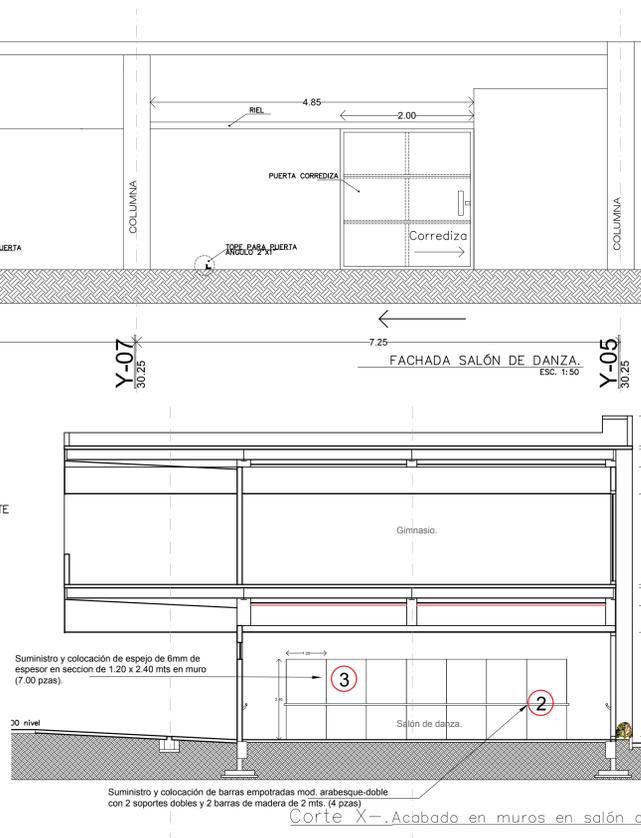
Corte X-X'. Acabado en muros en salón de danza.
